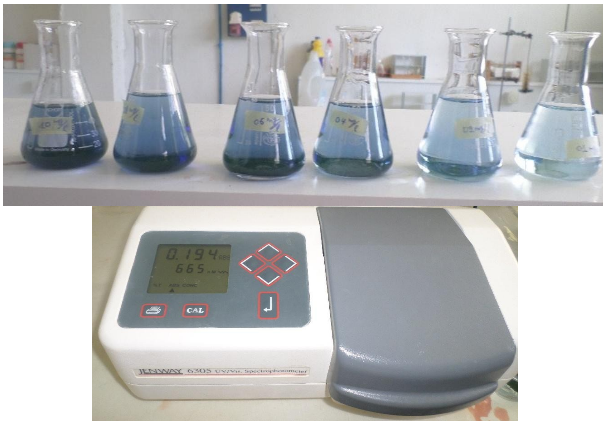
Figure IV.5 : dosage spectrophotométrique de la solution de BM
