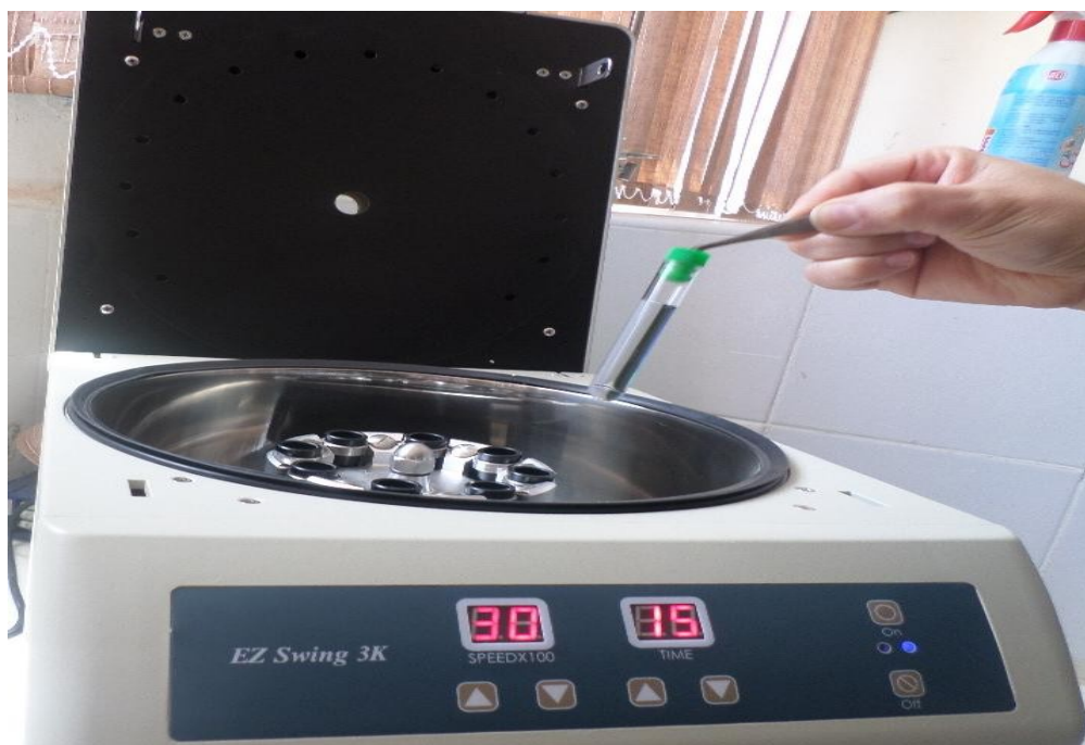
Figure IV.4 : la centrifugation du mélange de BM et charbon actif
