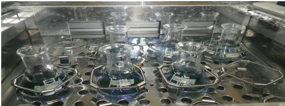
Figure IV.3 : l'adsorption de BM sur le charbon actif
