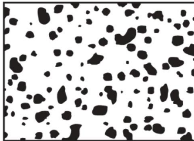
Figure I. 9 Matériau FGM à deux phases avec microstructure particulaire.
