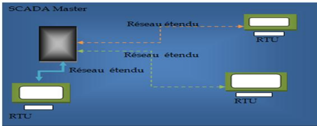
Figure I.8: Architecture des systèmes Monolithique[7]
