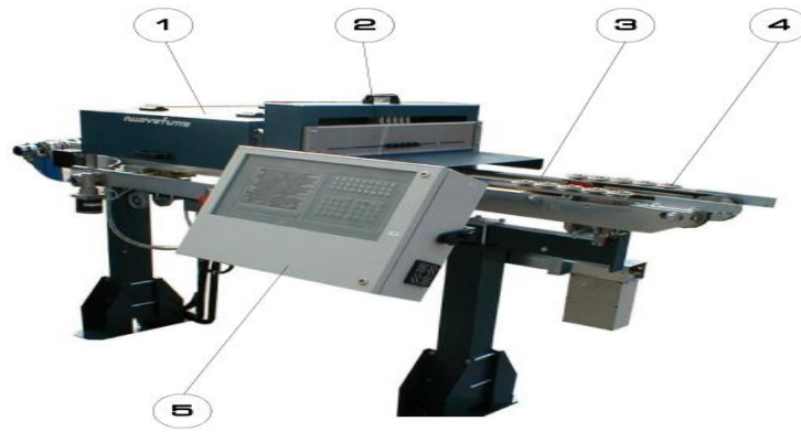
Figure II.37. NEW CHECK : appareils de contrôle automatique de planarité et calibre carreaux[31]
