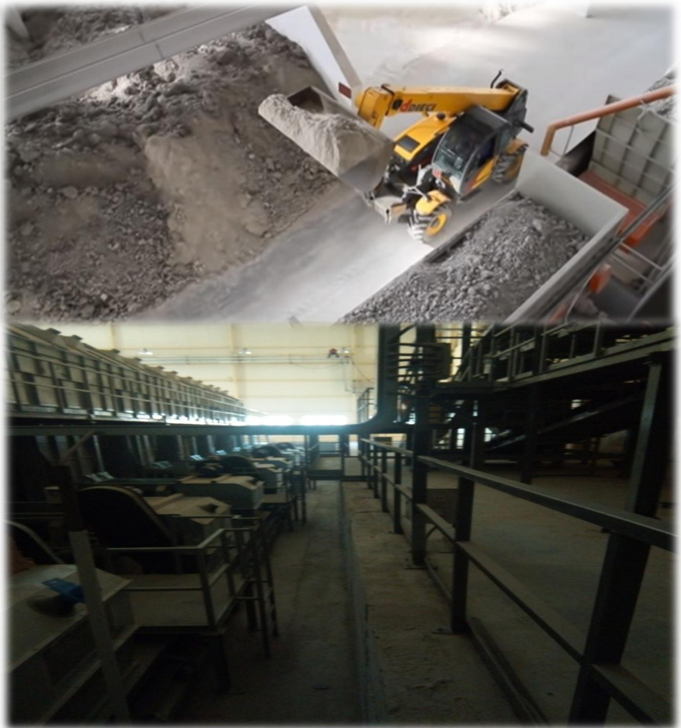
Figure II.8:chargement d'argile dans les trémies. .[4]
