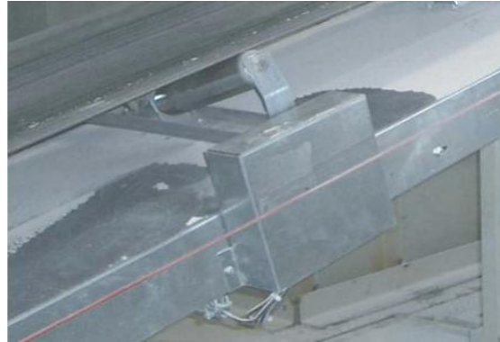
Figure II.10: Pont de Pesage Pour Convoyeur de Transport. [5]
