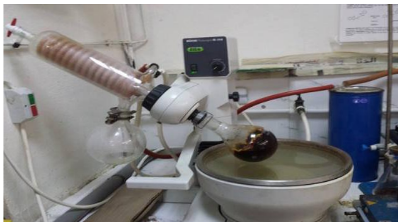
Figure II.2 : Evaporation de la solution dans un évaporateur rotatif.
