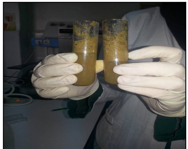
Fig 15 : la destruction de la matière organique par le peroxyde d'oxygène
