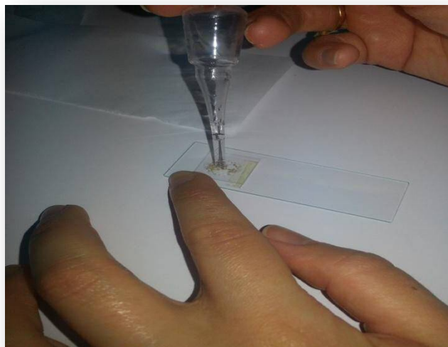
Fig 19 : la déposition d'une goutte d'huile d'émersion
