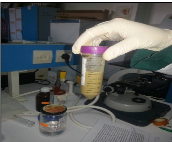
Fig 15 : la destruction de la matière organique par le peroxyde d'oxygène
