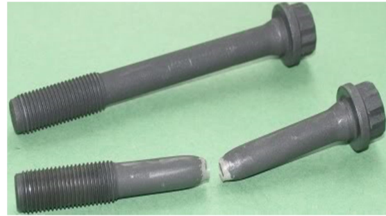
Figure 6. Rupture d'un tirant
