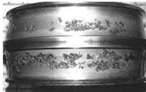
Figure 19. Détérioration d'une bague de roulement
