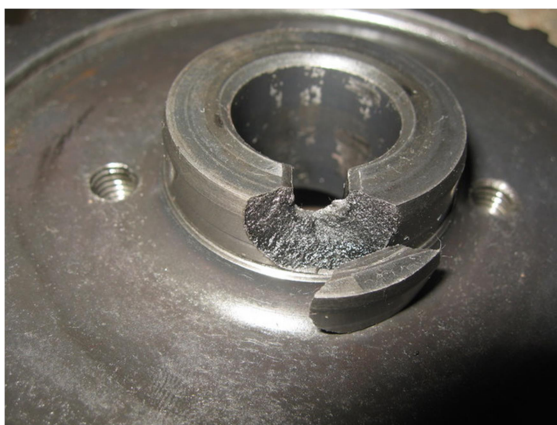
Figure 3. Détachement d'une partie d'une roue dentée
