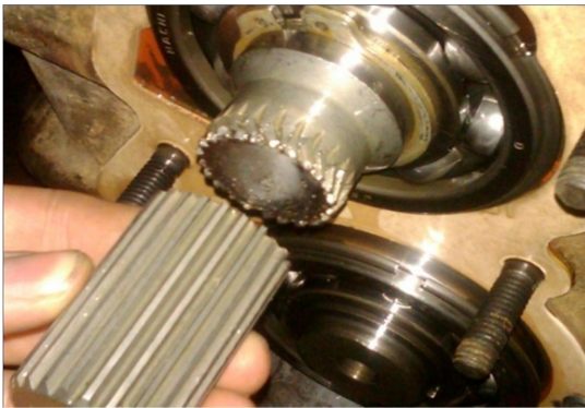
Figure 7. Rupture d'un arbre cannelé
