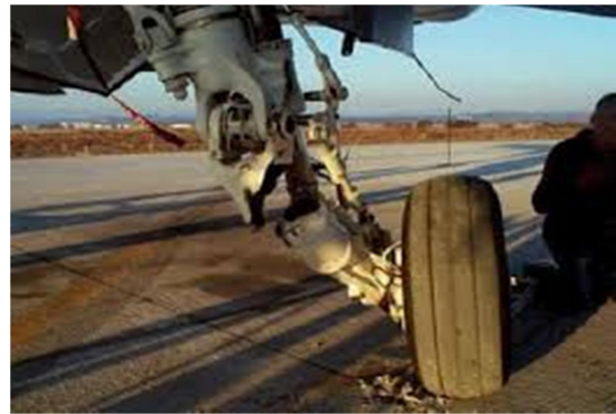
Figure 8. Fissuration au niveau du mécanisme d'atterrissage d'un avion
