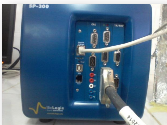
Figure III.4. potentiostat/galvanostat (PG) utilisé pour l'analyse électrochimique.
