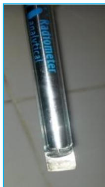
Figure.III.7. L'électrode de travail ( de platine )
