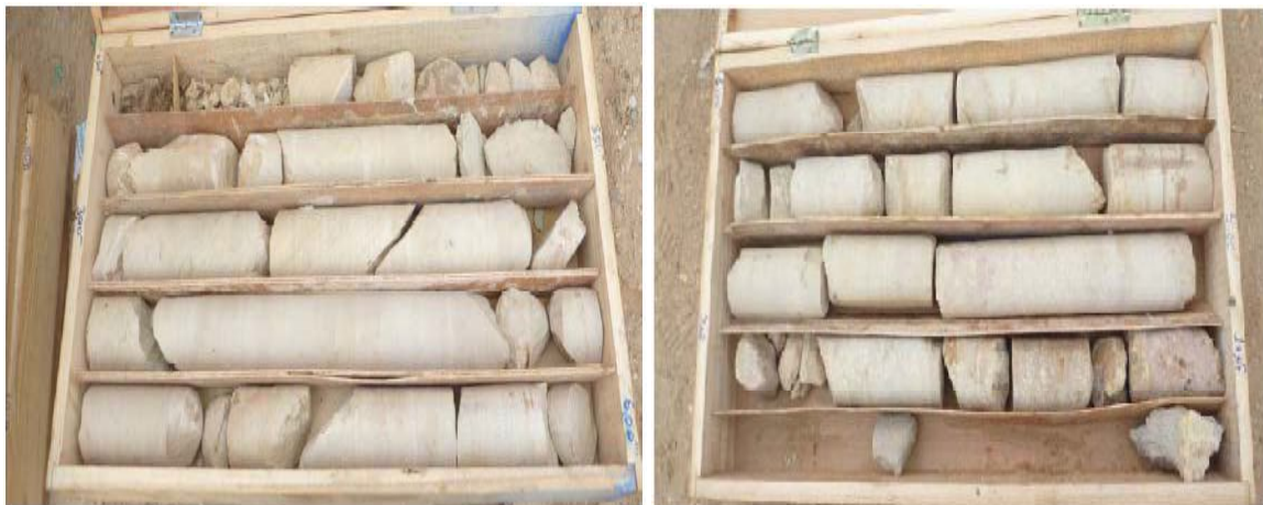
Figure V.8: Sondage SC-205 entre 0 m et 10 m de profondeur. Détail du groupe géotechnique Ct, grès fin à très fin, avec ciment siliceux.
