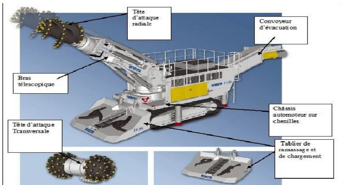
Figure III.19 : machine à attaque ponctuel
