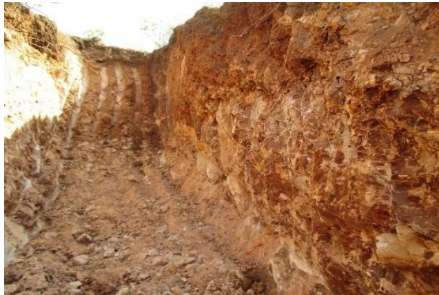
Figure V.6 : Puits de reconnaissance réalisé dans le portail d'entrée sur l'unité C.T
