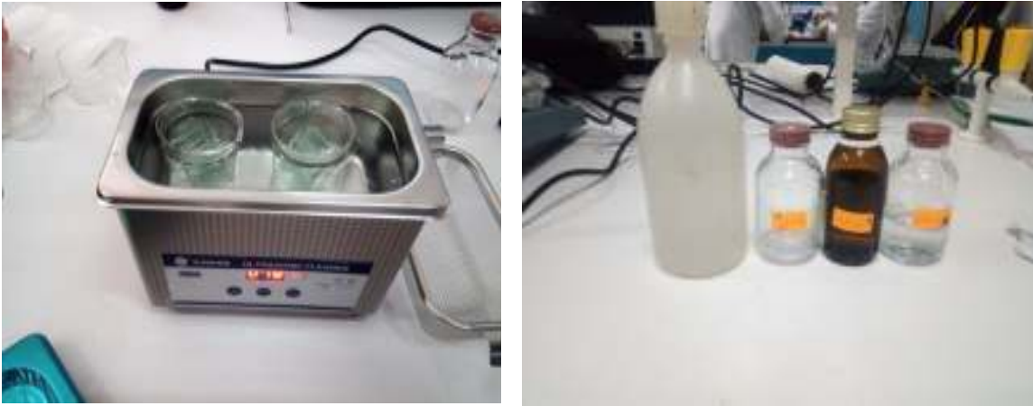
Figure II. 4 : Appareil ultrason et les matériaux utilisé dans le nettoyage des Substrats
