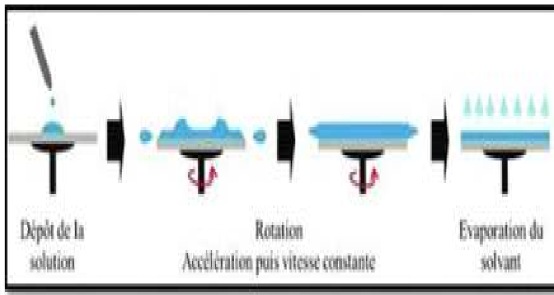
Figure I.11 : Schéma de principe de spin-coating [49].
