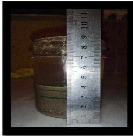
Figure15 : détermination de la texture du sol
