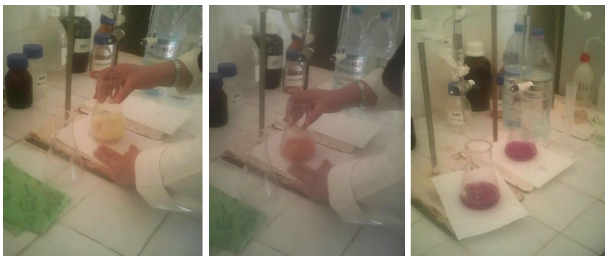
Figure 30 : Dosage de chlorure
