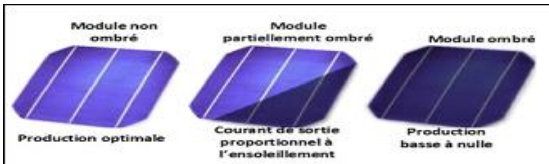
Figure 11: Exemples d'ombrage sur modules PV
