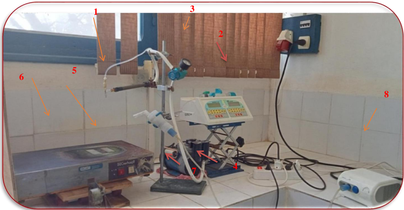
Figure II.2. Montage de spray pyrolyse expérimental utilisé.
