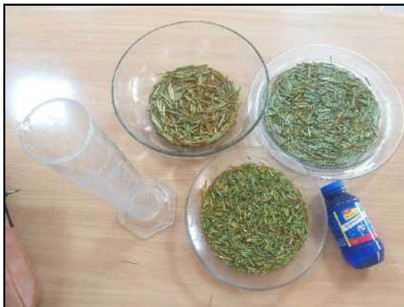
Figure II.10 : Différents matériaux de traitement (fibres brutes de Diss découpées 1cm, 2cm et 3cm, tube d'eau distillée et flacon de l'hydroxyde de sodium)
