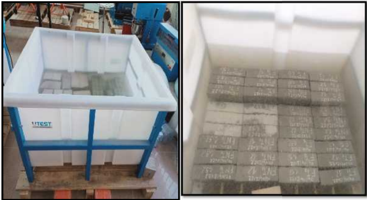
Figure II.14 : Conservation des éprouvettes dans une cuve d'eau.
