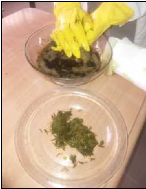
a) lavage des fibres traitées
