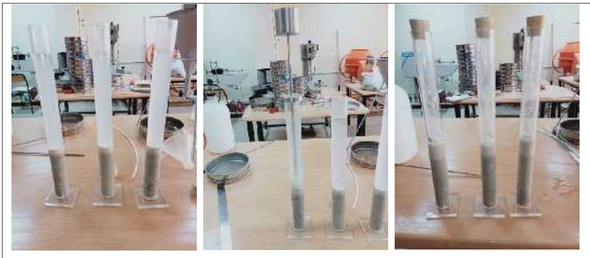
Figure III.2 : Principe de l'essai d'équivalent de sable
