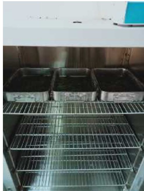
b) séchage des fibres dans l'étuve à 60°C
