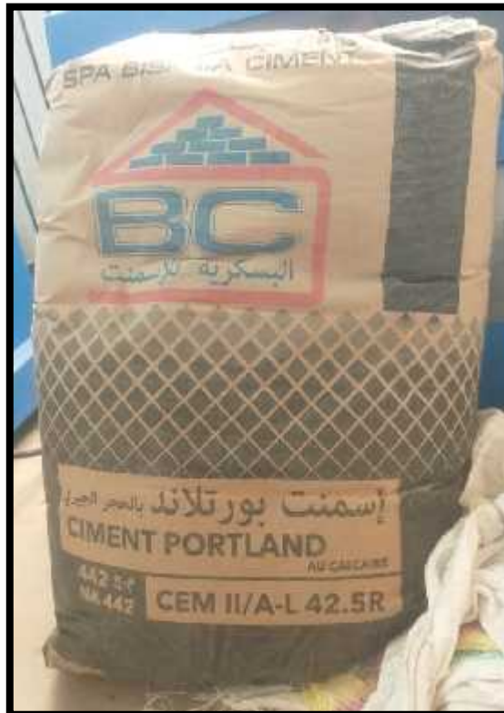
Figure II.3 : Sac de Ciment Portland (CEM II, 42.5 R) de la cimenterie de Biskra
