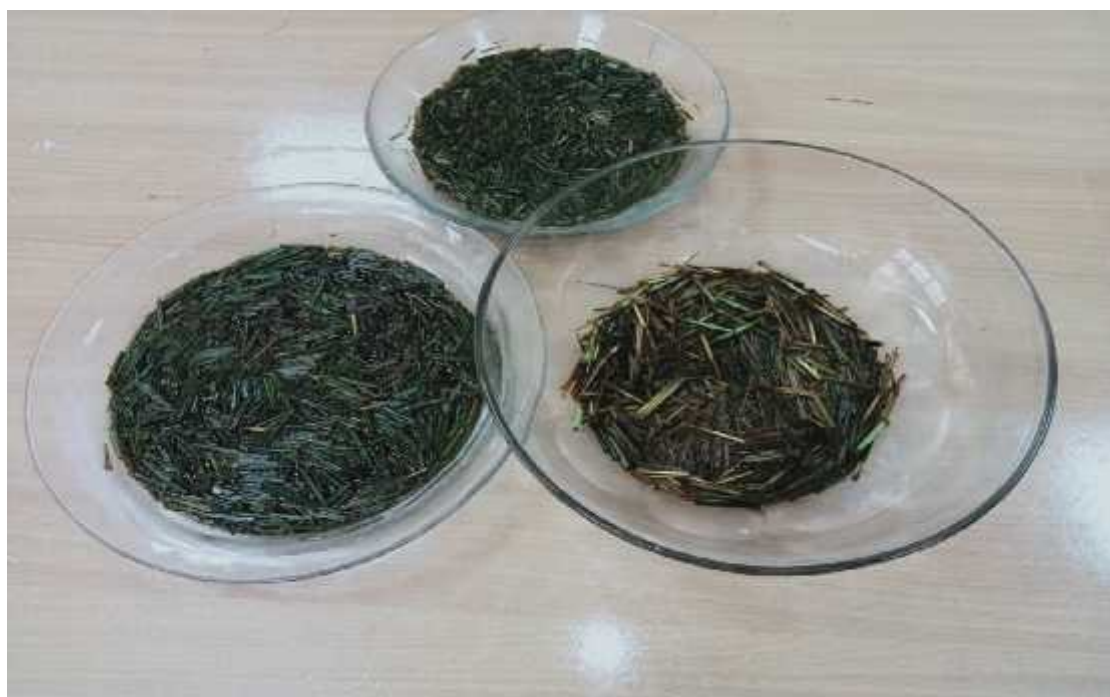
Figure II.12: Fibres de Diss découpées (1cm, 2cm et 3cm) immergées dans la solution NaOH
