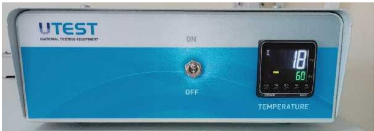
c) Fibres de Diss placées dans une étuve de séchage à une température 60° C durant 5 heures
