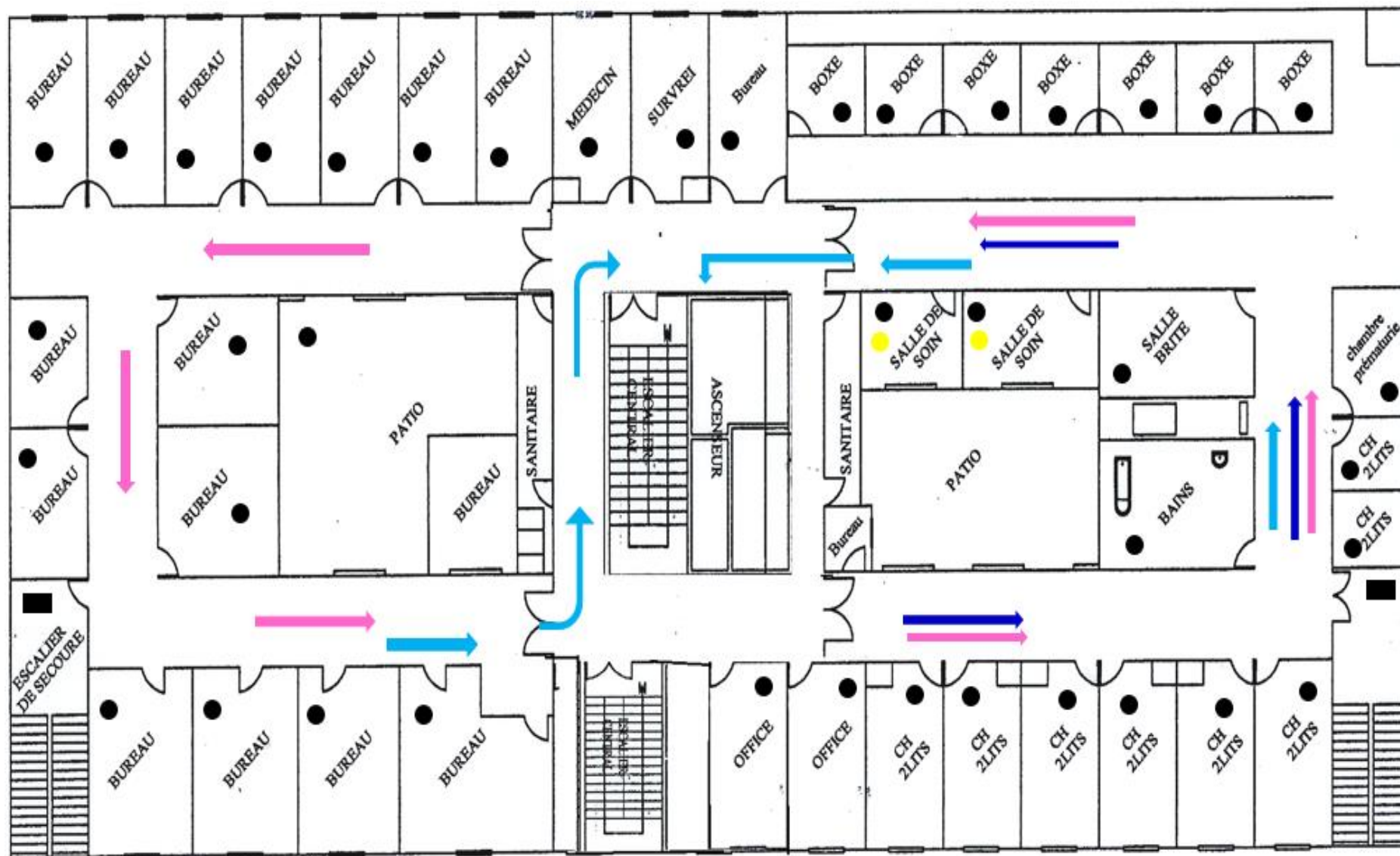
Figure 33 : Plan de gestion des DAS et DAOM dans le 1 er étage (administration et pédiatrie).
