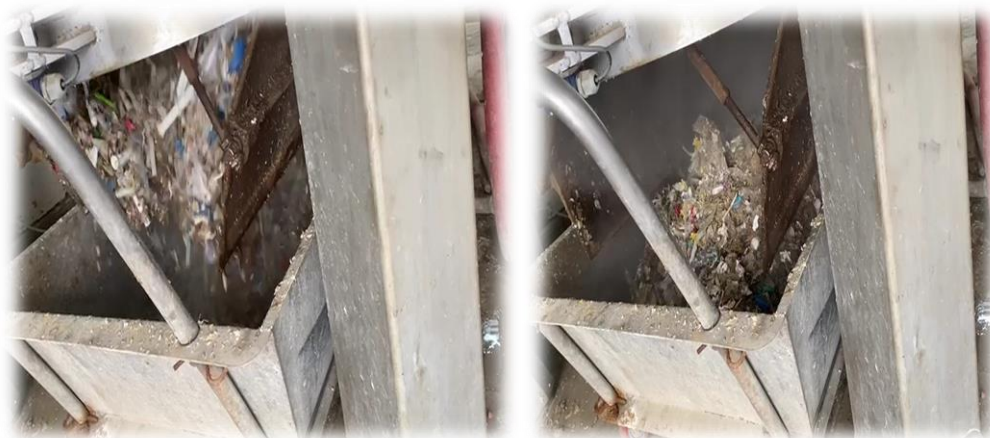
Figure 16 : Déchargement des broyats stérilisés.
