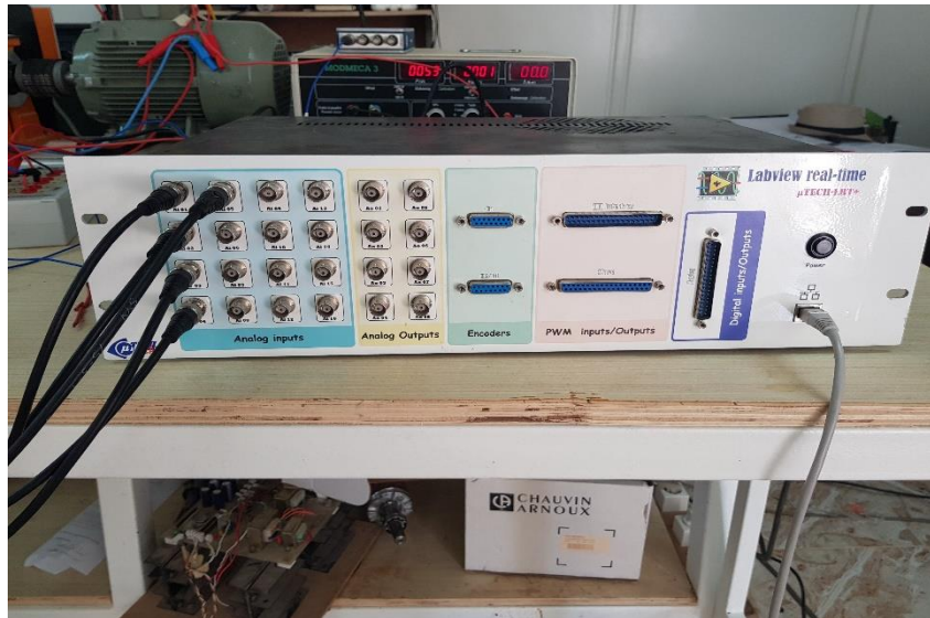
Figure.IV.10 : La Plateforme temps réel programmable \mu TECH-LRT+ de NI
