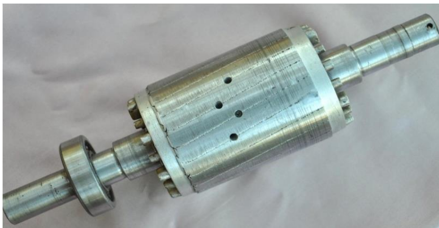
Figure. IV.43: Rotor d'une MAS avec plusieurs cassures des barres
