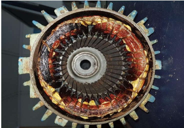
Figure. I.6 : Défaut d'isolant dans un enroulement statorique
