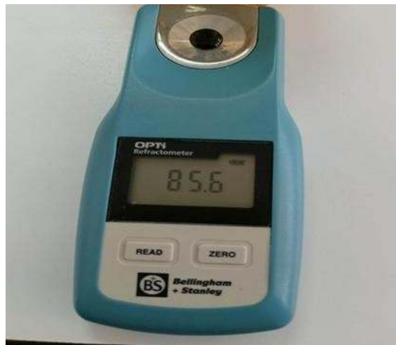
Photographie 4. Réfractomètre de type Bellingham + Stanley.
