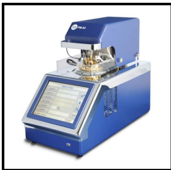
Figure III.2: Appareil automatique de la détermination du point d'éclair [1].
