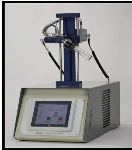
Figure III.4: Appareil automatique pour la mesure du point de trouble et d'écoulement [1].
