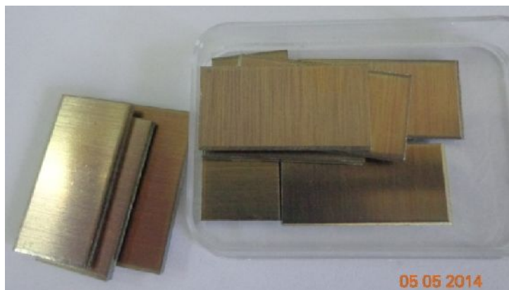
Figure II-6 : Échantillons oxydés 7 heures à 700°C (973 K).
