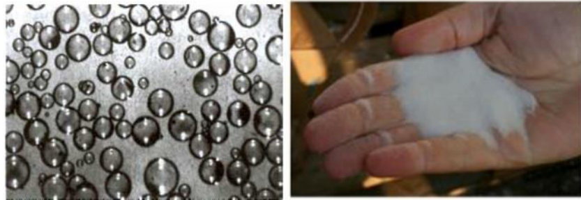
Figure (1.6) Microsphères de verre observées par microscopie optique.
