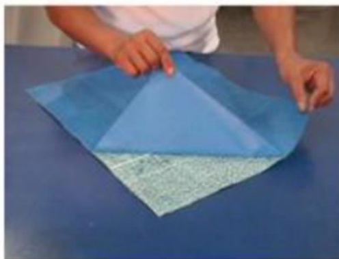
Figure (1.23) Une feuille de pré-imprégné verre/époxy et son film de protection (image Airtech)
