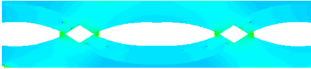
Figure (3. 24) Les contraintes ( \sigma_{xx} ) dans la matrices et les positions des points critiques (modèle 1, traction.)
