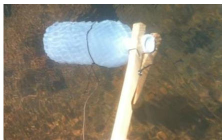
Fig.17 : Technique de prélèvement des échantillons.
