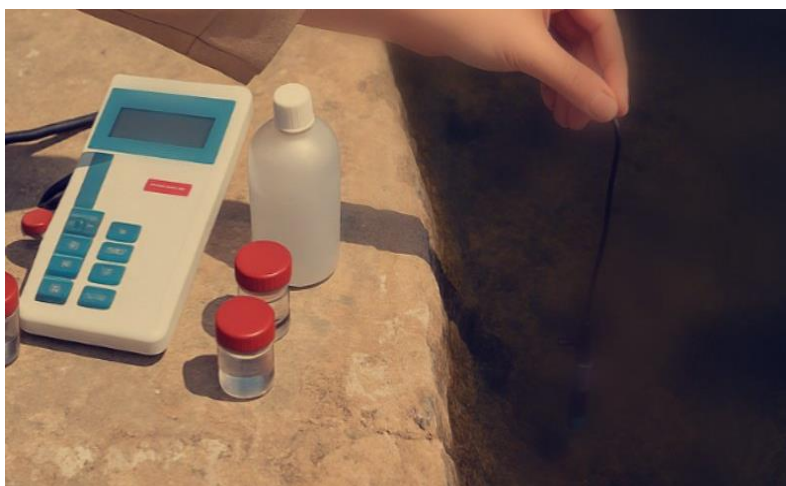
Fig.19 : Mesures des paramètres physico-chimiques In Situ.
