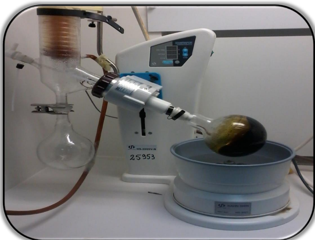
Figure 8. Photo du Rotavapeur utilisé pour sécher notre extrait méthanolique.
