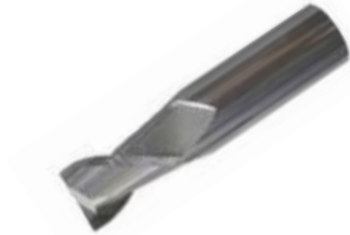
Fig. II .43 : Fraise 2T à queue cylindrique
