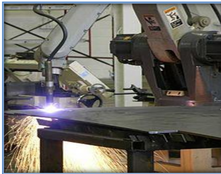
Fig. I.59 Découpage plasma réalisé par un robot industriel.
