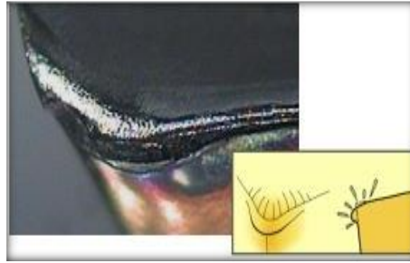
Fig. II.32. Usure thermique (déformation plastique)
