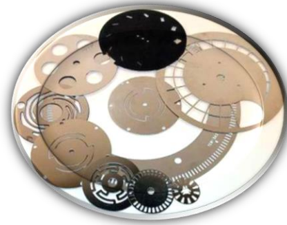
Fig. I.60 Pièces réalisées par usinage photochimique.
