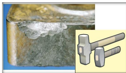
Fig. II.30. Usure mécanique (Ecaillage).
