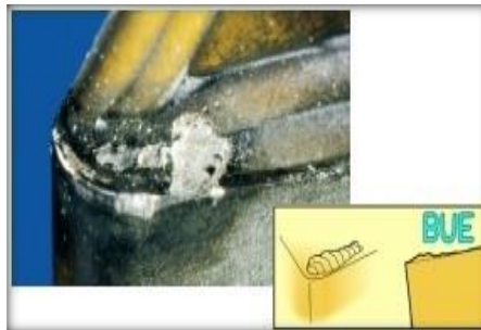
Fig. II.31. Usure par adhérence (Arête rapportée).
