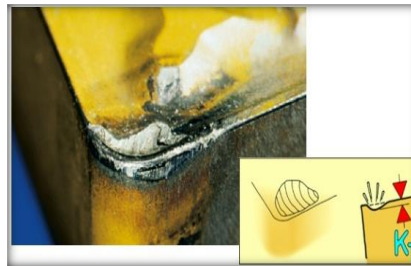
Fig. II.29 : Usure en cratère (chimique).
