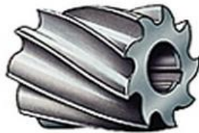
Fig. II.41 Schéma d'une fraise rouleau.
