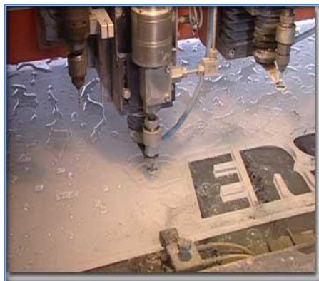
Fig. I.58. Découpage par jet d'eau.
