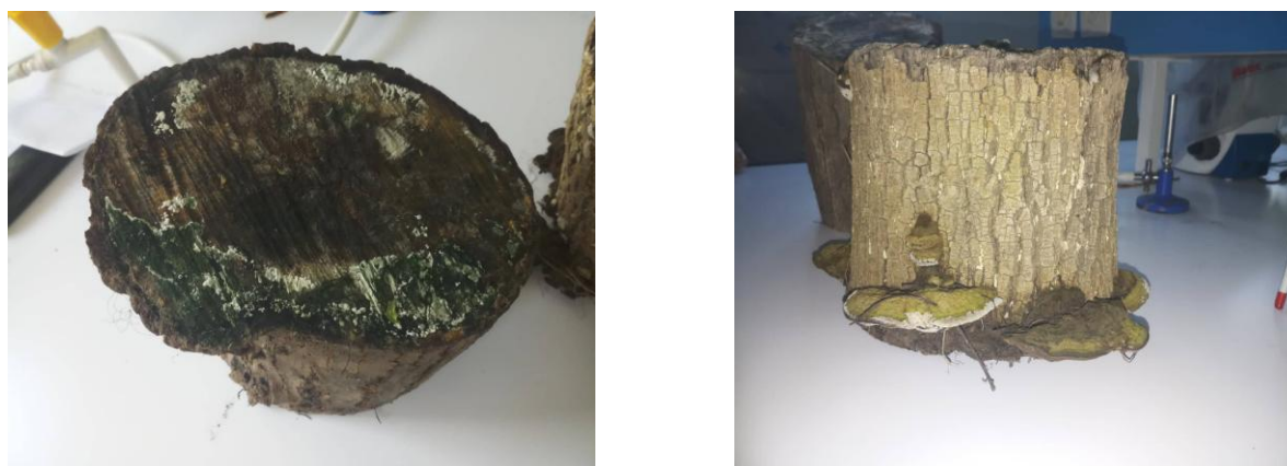
Figure 9 : Echantillons de bois de pin d'Alep infestés de champignons.
