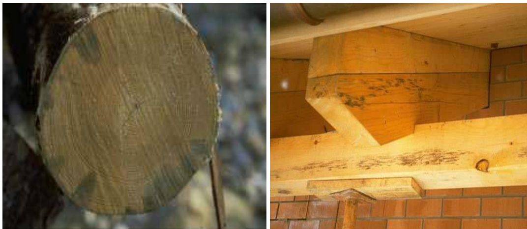
Figure 1 : Photographies des dégradations liées au bleuissement sur bois fraîchement abattus (à gauche), ou en service (à droite) ( Gérardin, 2008 ).
