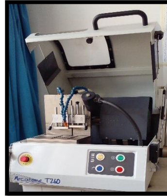
Figure III.7. Tronçonneuse à disque lubrifié.
