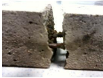
Figure 10. Eprouvette avec tiges après rupture du mortier
