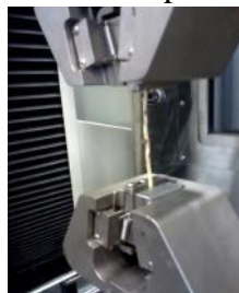
Figure 4. Dispositif d'essai de traction sur une tige (branchette) de dattiers
