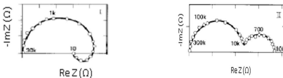
Fig.II.25. Diagramme d'impédance dans le cas des réactions hétérogènes avec adsorption.
