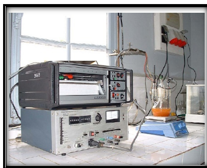
Fig.II.17. Installation de mesure des courbes de polarisation potentiostatiques.
