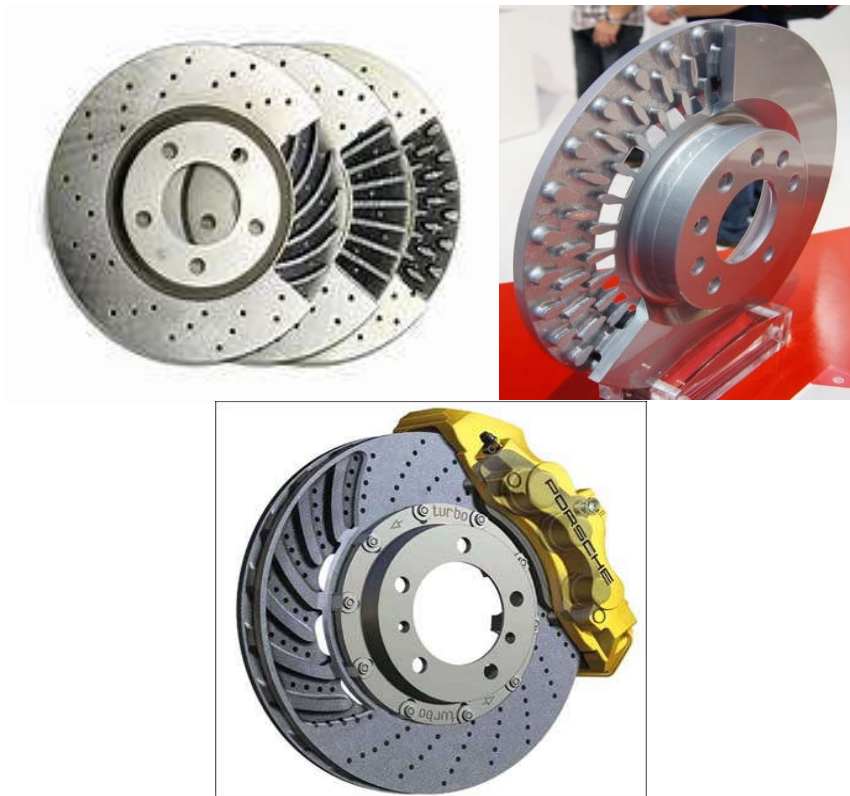
Figure I.17 : Différentes technologies de ventilation des disques.
