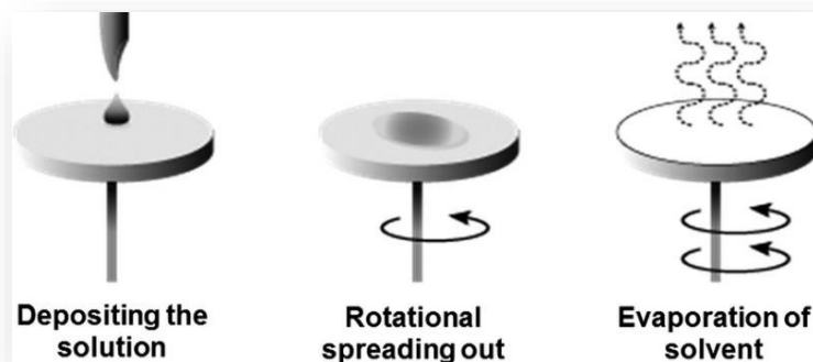
Figure II.11. Principe de dépôt par spin-coating.
