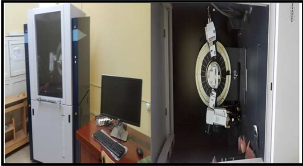
Figure III.9 : Diffractomètre à rayons X type Bruker D8 Advance (Laboratoire de recherche LSPN-Université de GUELMA, Algérie).
