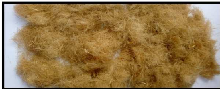
Figure III.2 : fibre de lin.
