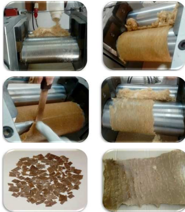
Figure III.5 : Méthode d'élaboration des plaques bio composites entre les deux cylindres.
