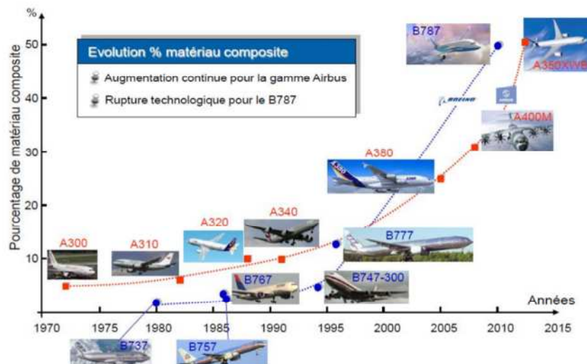
Figure I.9: Croissance du pourcentage de matériau composite en aéronautique au fil des années [18].
