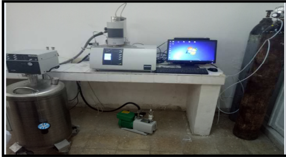
Figure III.10 : Calorimètre différentiel à balayage de marque NETZSCH.DSC/TG CC 300 (Laboratoire de recherche LSPN-Université de GUELMA, Algérie).
