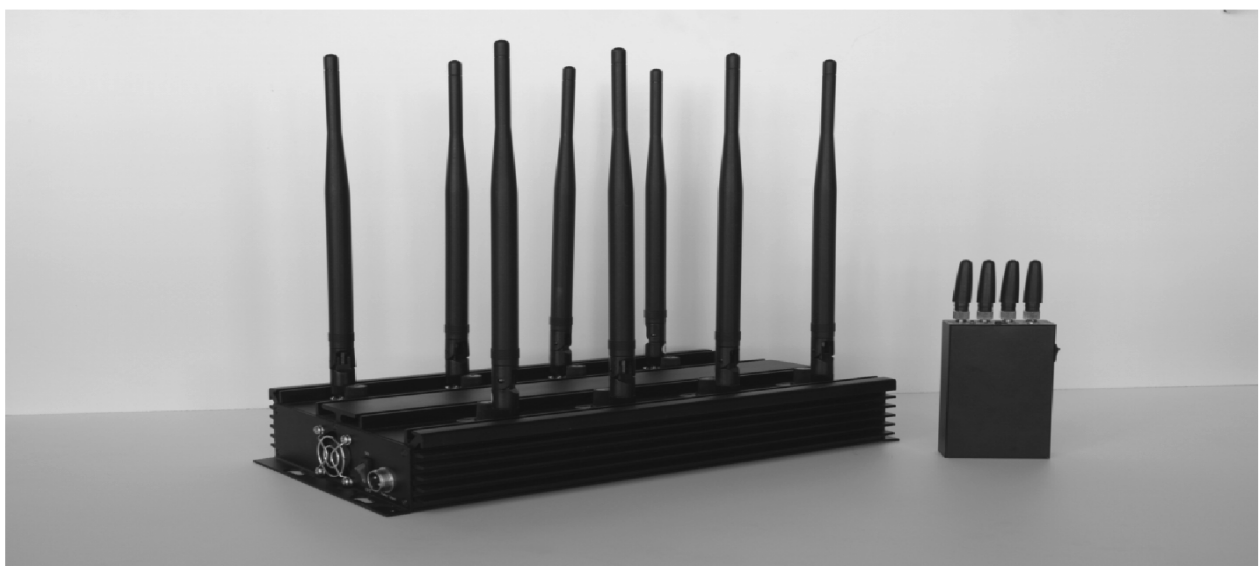
Figure 2.6 Exemples de brouilleurs GNSS multifréquences : brouilleur de bureau Réglable (à gauche) et dispositif portatif à quatre antennes (à droite).
