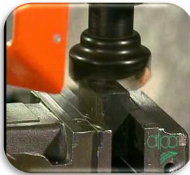
Fig. II.13 Opération de surfaçage.
