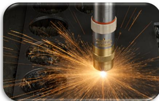
Fig. I.25 Découpage plasma réalisé par un robot industriel.
