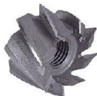
Fig. II.47. Fraise 2 T cylindriques à entraînement par tenons.
