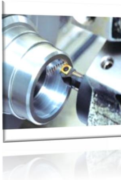
Fig. I.9 opération de réalisation d'un alésage.
