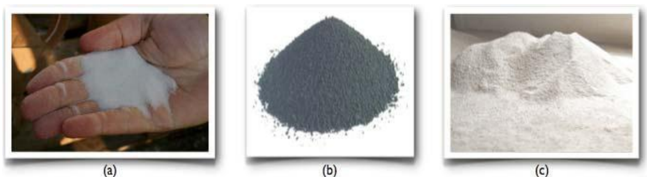
Figure (1.6) : Exemples de charges : (a) micro-billes de verre, (b) noir de carbone, (c) silice.
