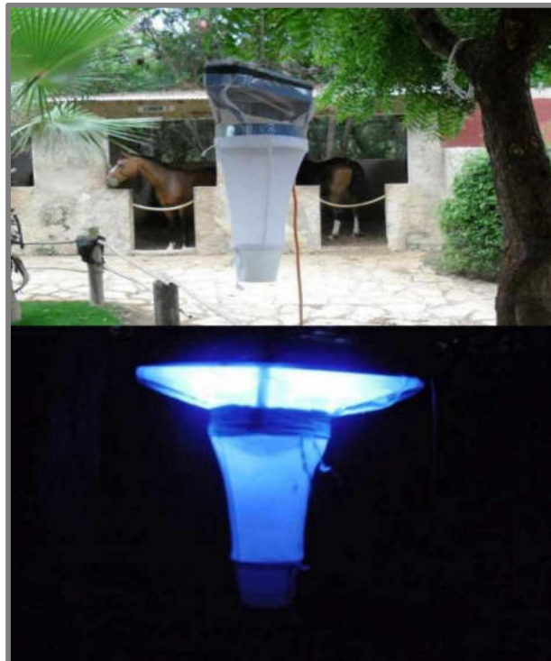
Figure 9 : Piège utilisé pour le suivi de la dynamique des Culicoïdes : piège lumineux de type OVI. (Dusom, 2012 )
