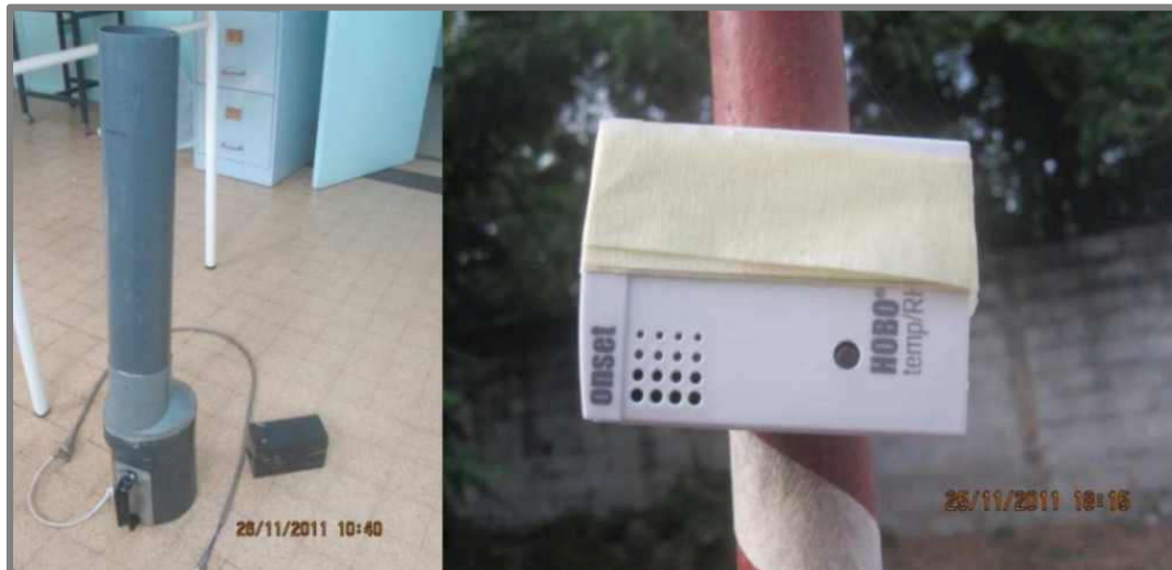
Figure 11 : Aspirateur avec batterie de 12volts à gauche et un enregistreur de température et d'humidité relative de type HOBO à droite( Dusom , 2012)
