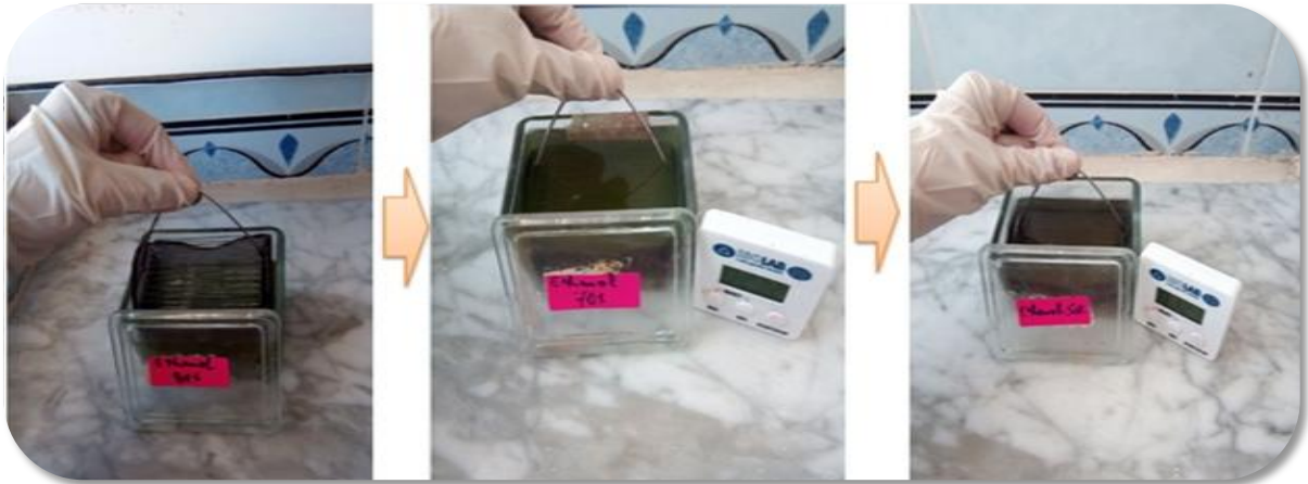
Photographie 08 : Etape d'hydratation dans des bains d'alcool de différentes concentrations
