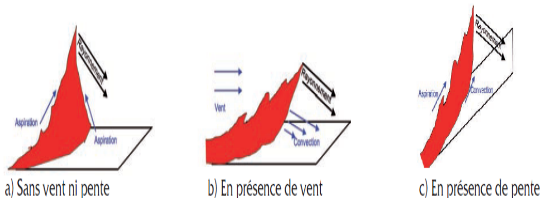
FIGURE 1.3 – Mécanismes de la propagation du feu. [9]
