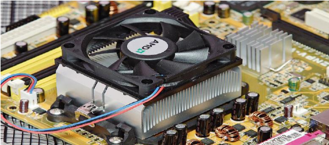
Figure I.1 : Un dissipateur de chaleur refroidi par ventilateur sur le processeur d'un ordinateur personnel. À droite, un dissipateur de chaleur plus petit refroidit un autre circuit intégré de la carte mère
