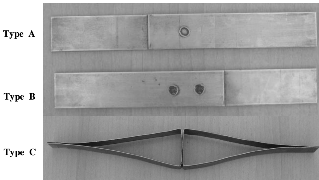
Figure IV.8. Type A) éprouvette de cisaillement à un seul point de soudure. Type B) éprouvette de cisaillement à deux points de soudure. Type C) éprouvette d'arrachement.
