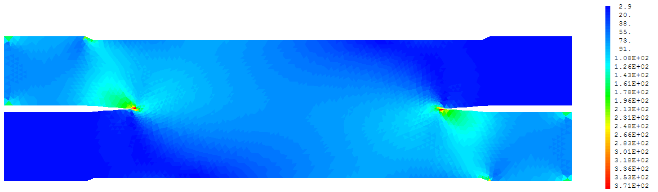
Figure V.15 : Distribution des contraintes de Von Mises
