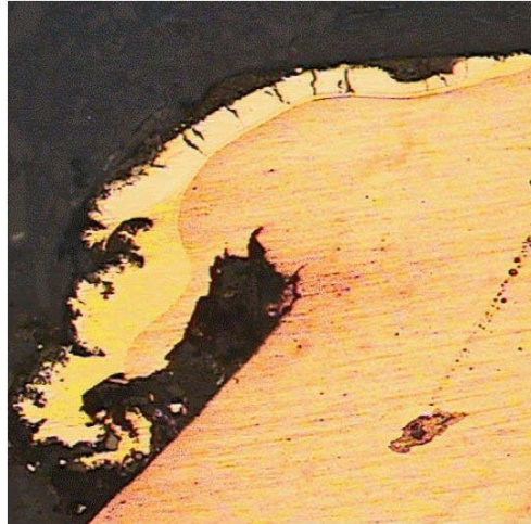
Figure I.11 : Apparition d'une dégradation typique d'une électrode dans le soudage de tôle revêtue, qui s'appelle le champignonnage ou « mushrooming » sur la surface active d'électrode [13].
