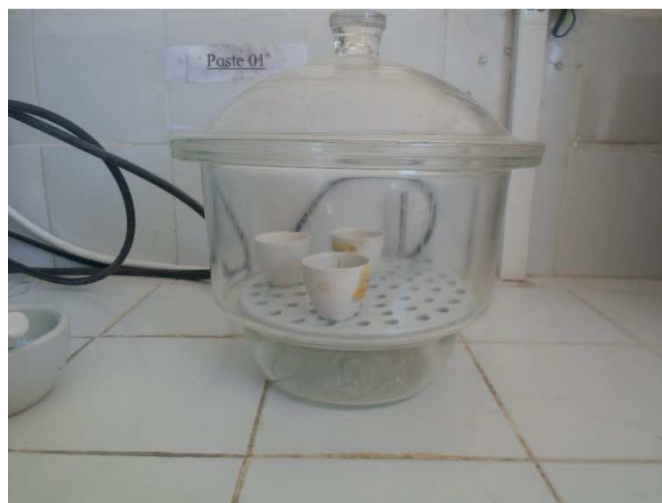
Figure 21 : Refroidissement dans le dessiccateur
