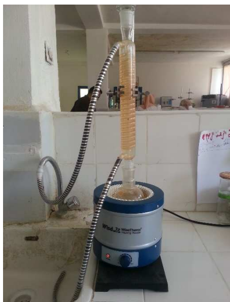
Figure 29: adaptation dans un réfrigérant à reflux.
