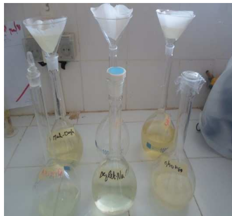
Figure 35 : La filtration des suspensions
