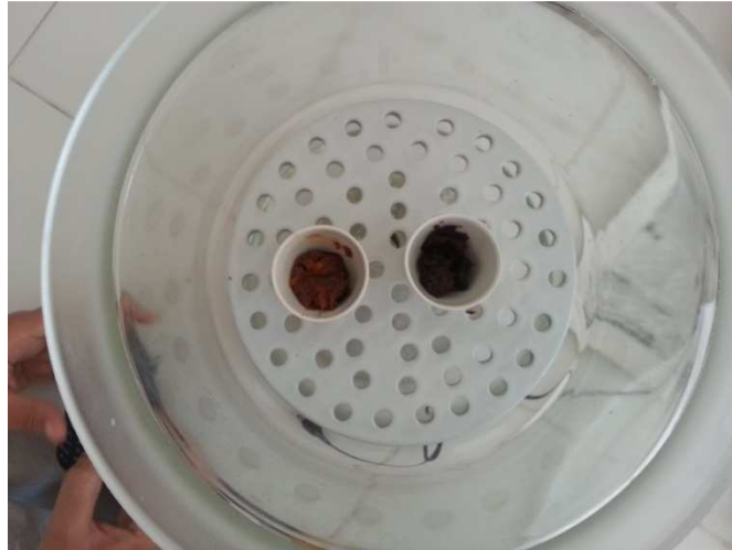
Figure 22 : Echantillons après étuvage (matière sèche)
