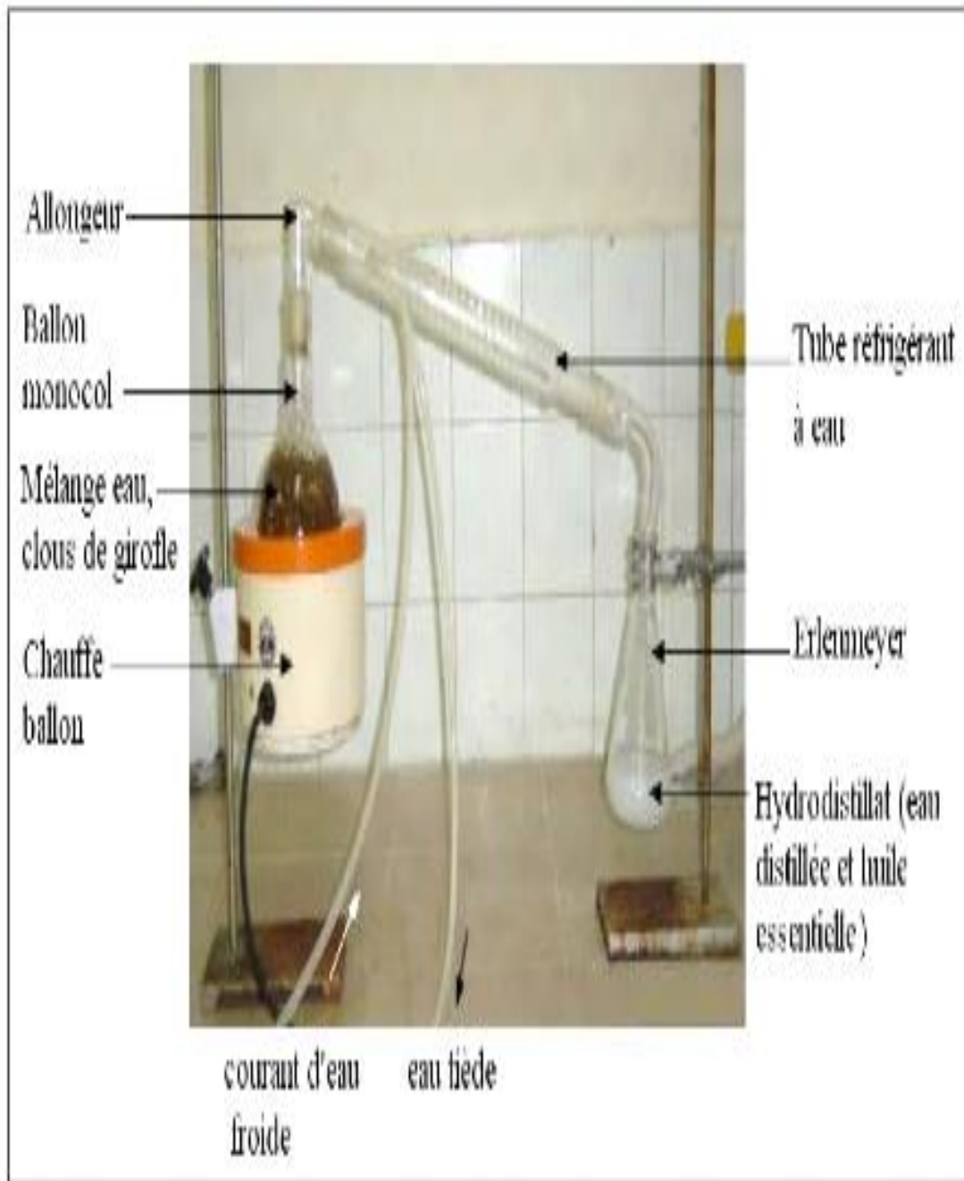
Figure IV .21 : Montage de distillation par entraînement à la vapeur d'eau.
