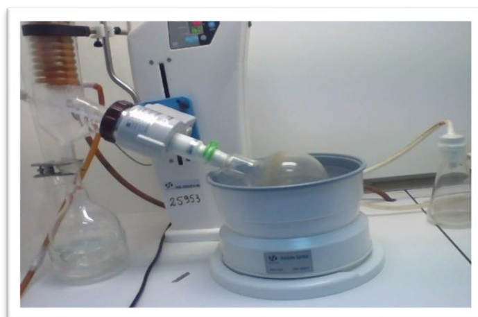
Photo.03: Photo du rotavapor utilisé pour sécher nos extraits aqueux.
