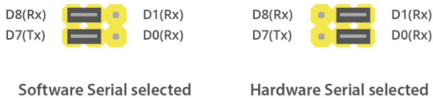
Figure II.30:le protocole UART pour communiquer avec un Arduino
