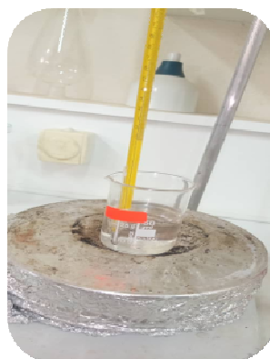
Figure 52: Montage de point de fusion.
