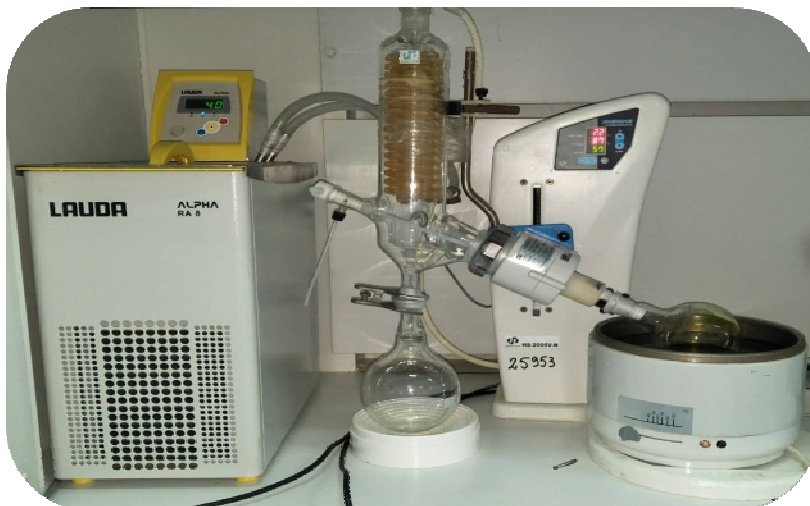
Obtention l'extrait brute de NC* Par évaporation dans un évaporateur rotatif sous pression réduite
