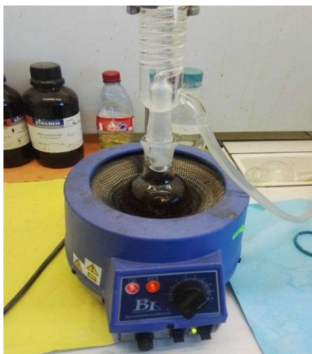
Figure II.1: montage de chauffage à reflux
