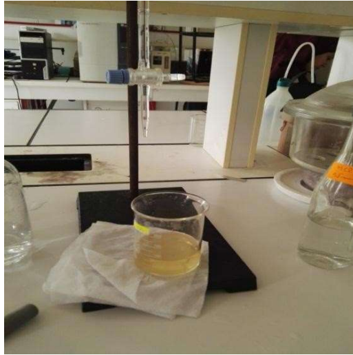
Figure III.2 dosage huile d'olive par Hcl
