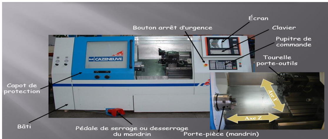
Figure. III.7. Tour à commande numérique
