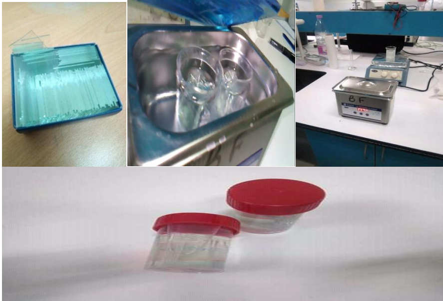
Figure II.1: Procédure de nettoyage des substrats dans un bain à ultrasons.
