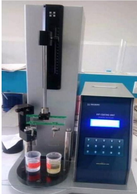
Figure II.3 : Dispositif de dépôt des couches minces par dip-coating.
