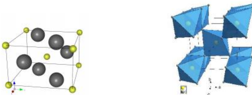
Figure I.4: Structure de la phase rutile du TiO 2 [11].
