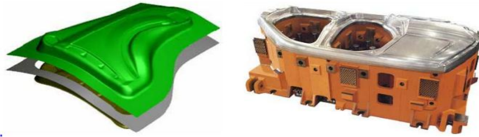
Figure I.4. Outils d'emboutissage d'aile d'une voiture (Documentation STAMPACK, Société QUANTECH).
