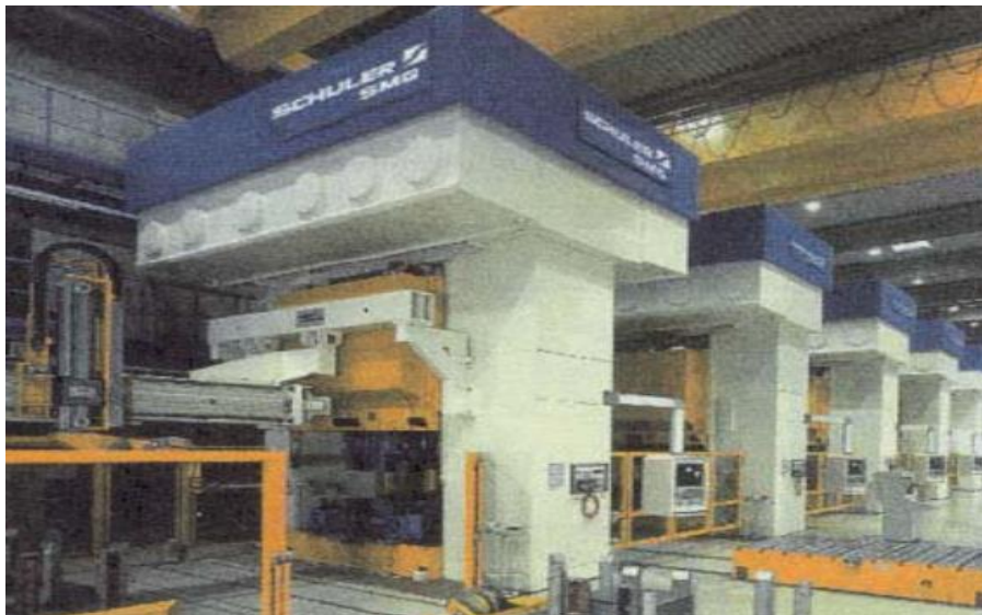
Figure I.5. Ligne de presses d'emboutissage.
