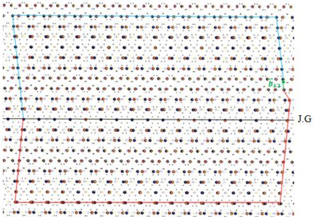
Figure III.11: Carte bicolore (dichromatic pattern) de la macle rhomboédrique autour de la disconnection 'b'. Les symboles correspondent aux nœuds de la matrice. Les cercles en bleu correspondent au cristal \lambda et en orange pour le cristal \mu . Le circuit de mapping est reporté en bleu dans le cristal \lambda , en rouge dans le cristal \mu . Le vecteur de Burgers est \vec{b}_{-3/4}
