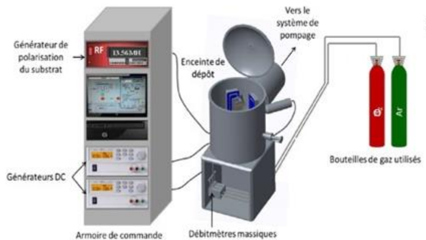
Figure II .3 :illustration de la pulvérisation cathodique magnétron (Plassys MEP 450).
