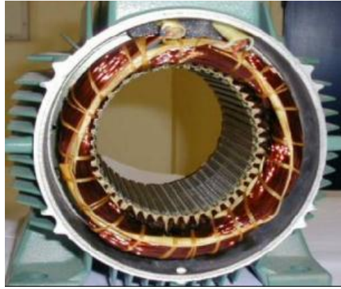
Fig.I.2: Le stator d'un moteur asynchrone triphasé
